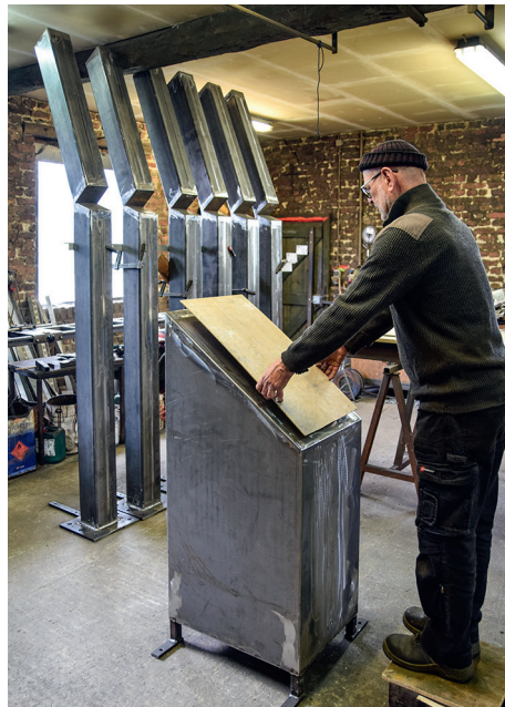
Der Schmied bei der Anpassung des Text-Pults mit Hilfe einer Schablone. (Foto: F.A. Heinen)
