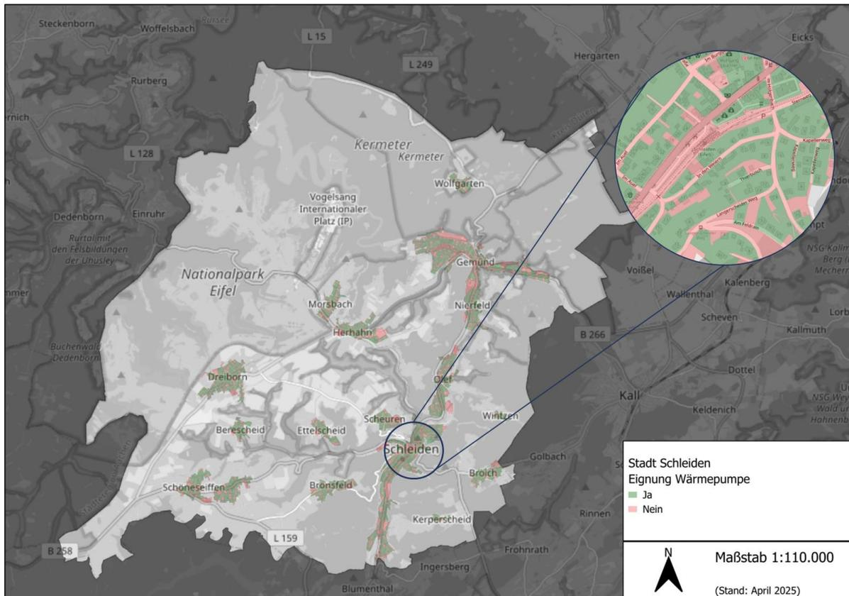
Abbildung 45: Eignungsgebiete für dezentrale Wärmepumpen in Schleiden
